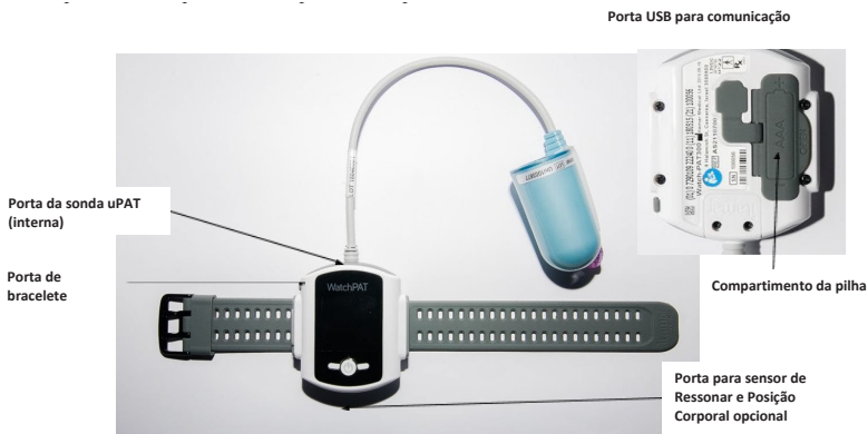
Figura 4 – Portas de serviço e periféricos
