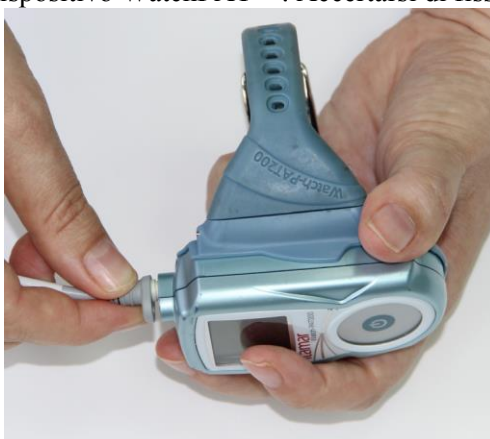
Figura 18 – Sostituzione della sonda uPAT
