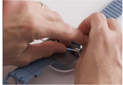
Figura 27 – Inserción de la batería
