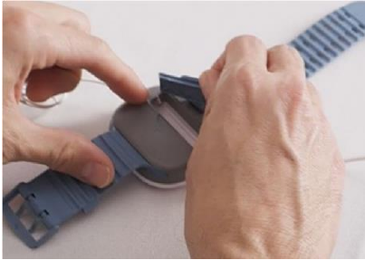
Figura 26 – Retiro de la batería
