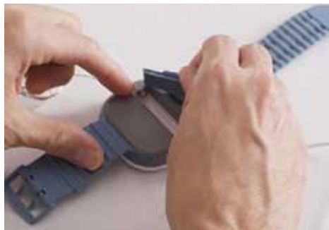
Figura 28 – Retiro de la batería
