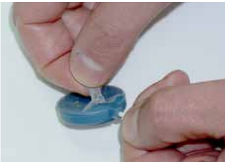
Figura 26 - Retiro de la etiqueta del sensor de pecho
