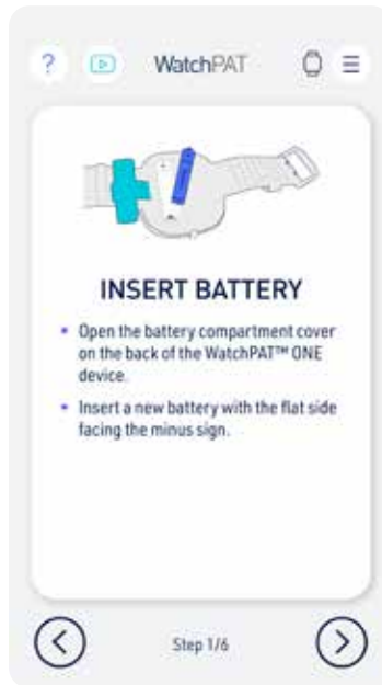
Figura 14 – Pantalla de inserción de la batería
