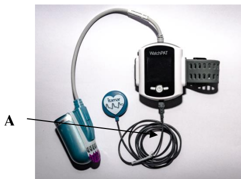
A - Geïntegreerde RESBP-sensor
