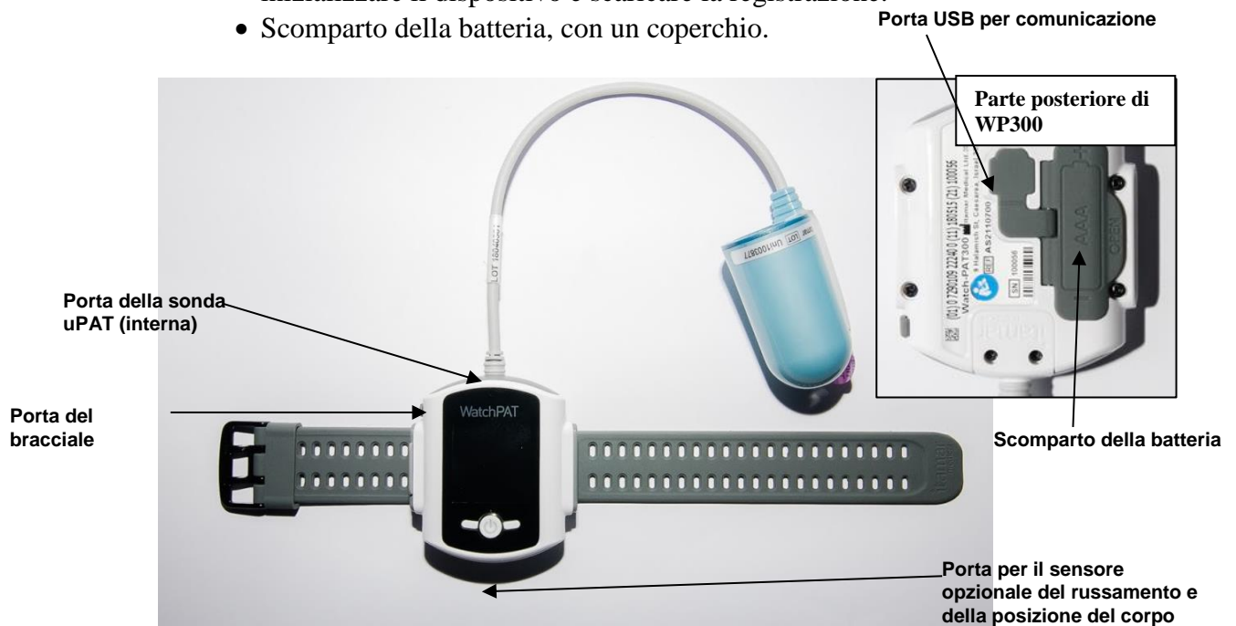
Figura 4 – Porte di manutenzione e periferiche
