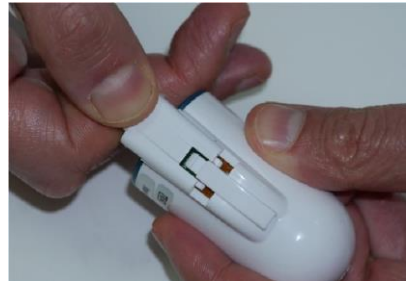
Figur 23 – Forbindelse af ny fingersonde
