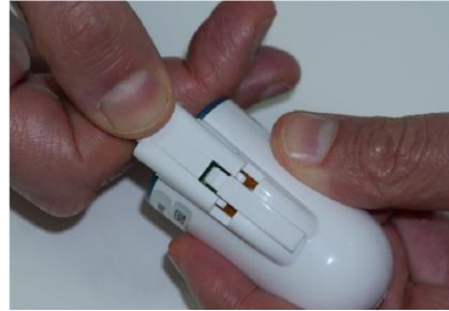
Kuva 23 – uuden sormianturin liittäminen
