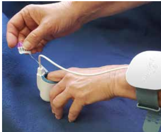
Kuva 8 – TOP-kielekkeen irrottaminen painamalla anturia samalla kovaa pintaa vasten
