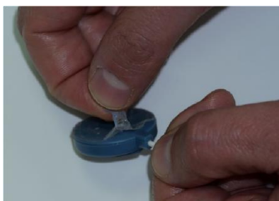
Figur 24 – Avlägsnande av etikett från bröstsensorn
