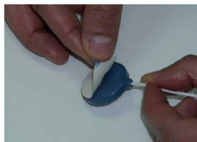
Figur 25 – Påsättande av etikett på bröstsensorn
