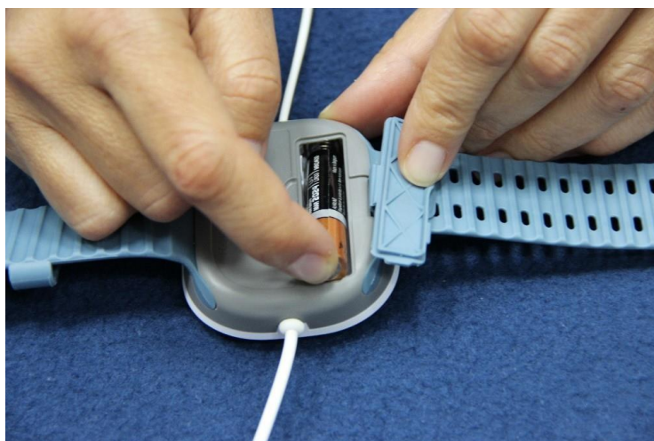
Figura 4 – Colocação da pilha
