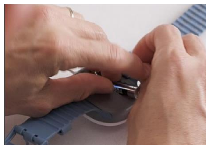
Figura 27 – Colocação da pilha
