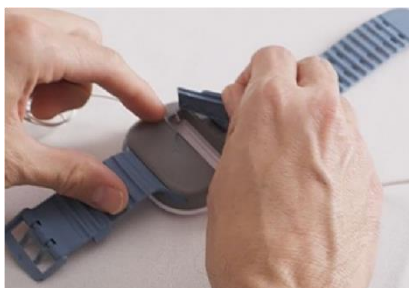
Figura 26 – Rimozione della batteria
