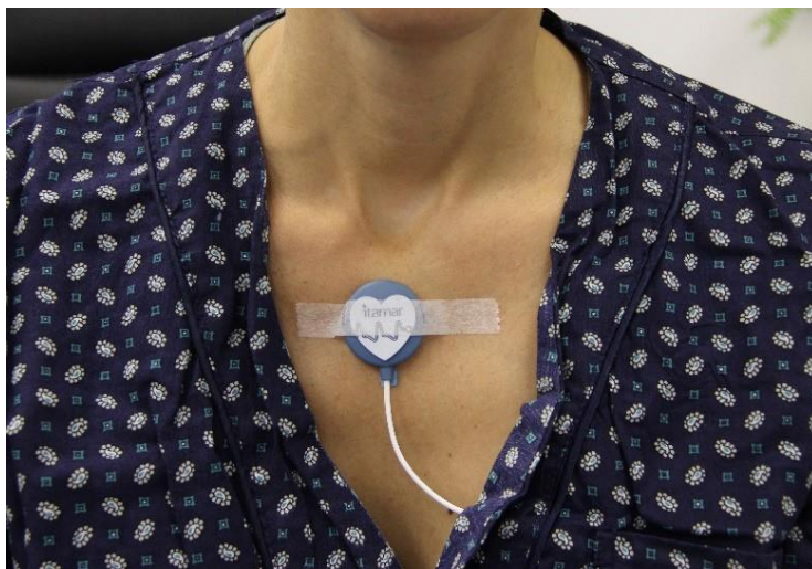
Figura 6 – Posizionamento del sensore toracico
