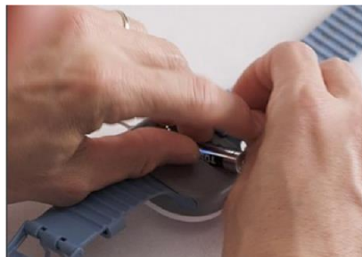
Figura 27 – Inserimento della batteria
