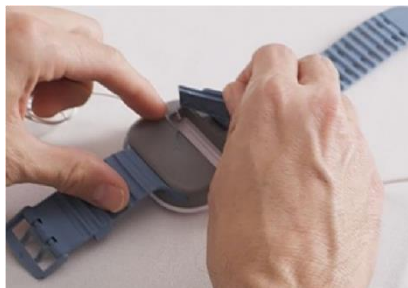
Figura 26 – Rimozione della batteria
