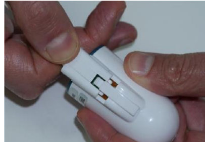
Figura 23 – Collegamento della nuova sonda a dito
