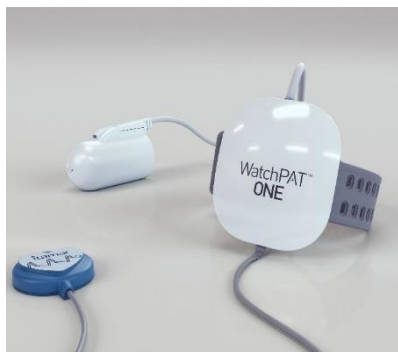
Figura 1 – Dispositivo WatchPAT (WPONE/WPONE-M e WPONE E)
