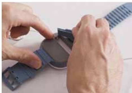
Figura 28 – Rimozione della batteria
