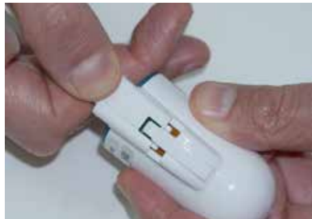
Figura 25 - Collegamento della nuova sonda a dito
