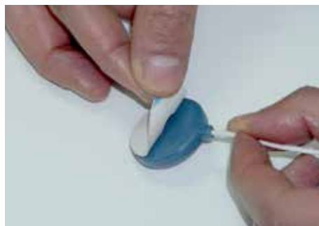
Figura 27 - Adesione dell'adesivo del sensore toracico
