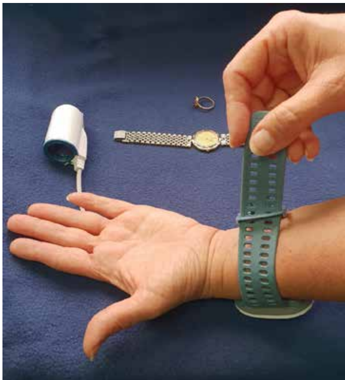
Figura 5 – Chiusura del dispositivo principale
