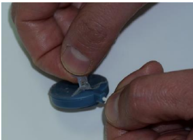
Abbildung 24 – Entfernung der Klebefläche des Brustsensors
