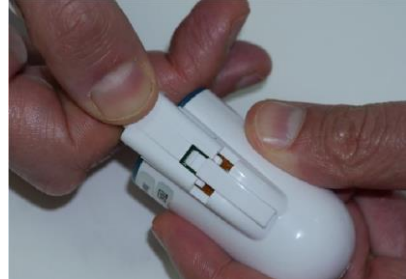
Abbildung 23 – Anschließen der neuen Fingersonde
