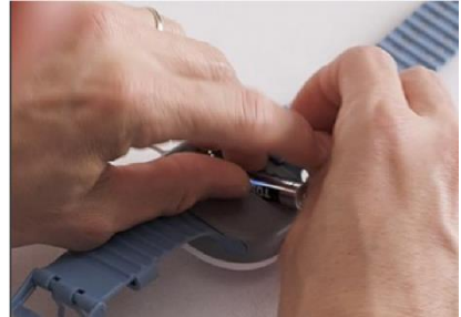
Abbildung 27 – Einlegen der Batterie
