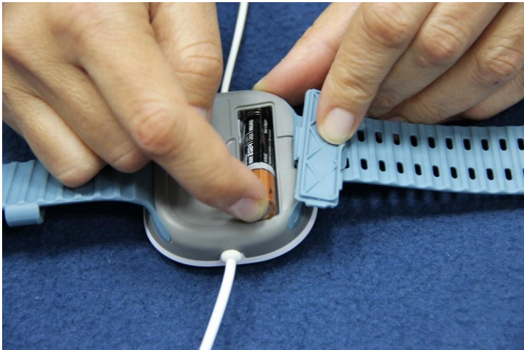
Abbildung 4 – Einlegen der Batterie
