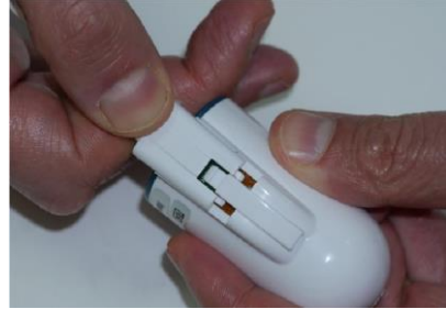
Afbeelding 23 – Aansluiten nieuwe vingersonde
