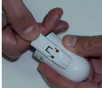
Figure 23 - Nouvelle connexion du capteur de doigt
