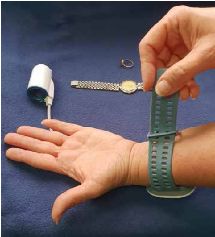
Figure 5 – Fixation du dispositif principal à l'aide de la sangle
