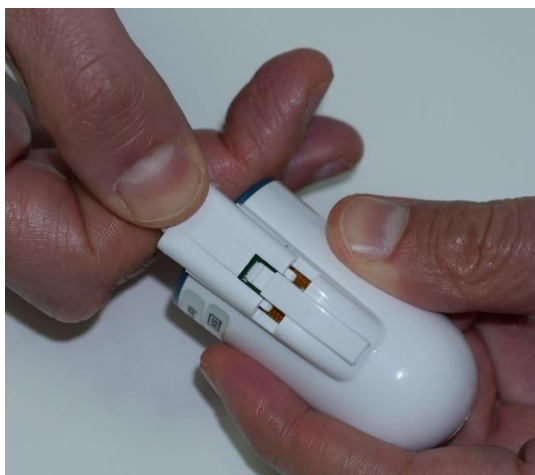
Slika 23 – Priklučitev nove prstne sonde
