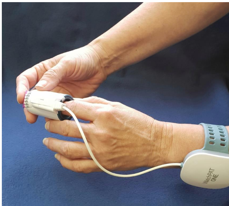
Slika 7 – Namestitev prsta v prstno sondo
