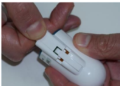
Slika 23 – Priklučitev nove prstne sonde
