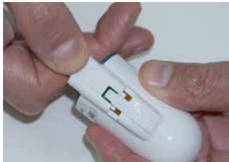
Slika 25 – Priključitev nove prstne sonde
