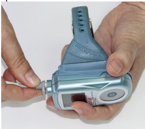
Figura 18 – Sostituzione della sonda uPAT
