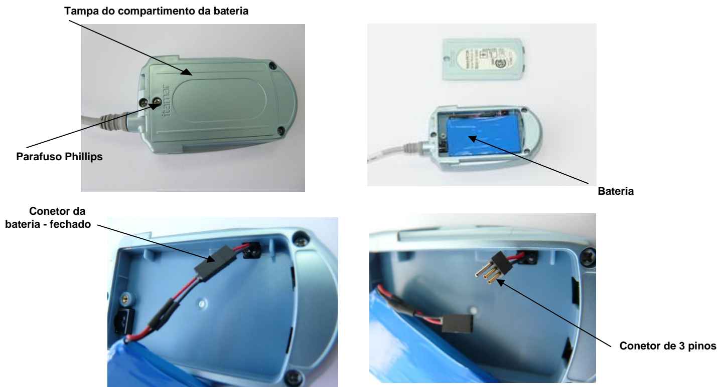
Figura 19 – Substituir a bateria
