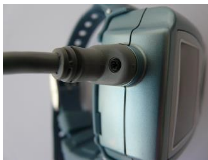
Figura 17 – Cabo da sonda uPAT com parafuso
