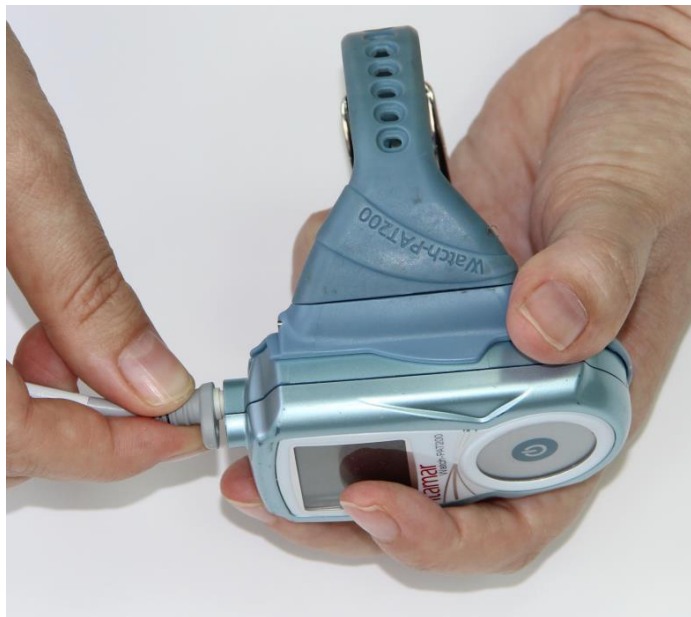
Figura 18 – Substituir a sonda uPAT
