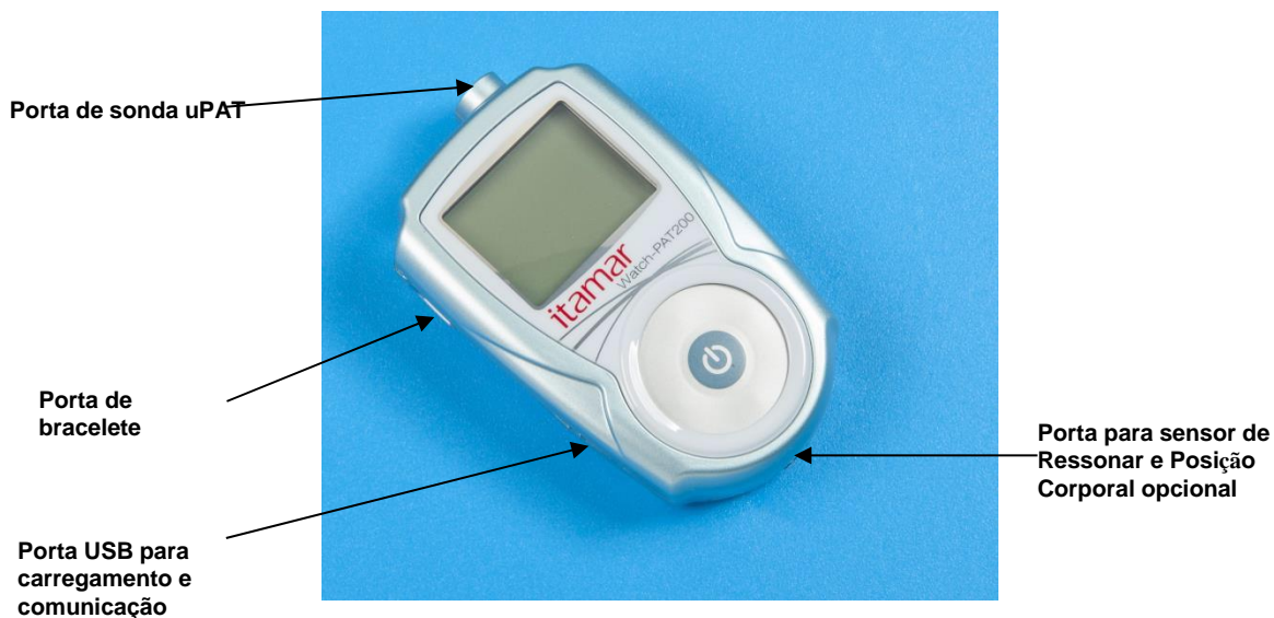
Figura 4 – Portas de serviço e periféricos
