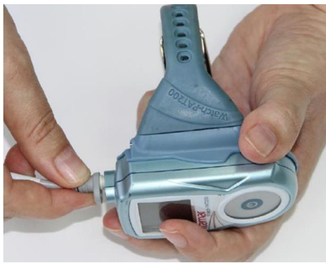
Figura 18 – Substituindo o biosensor uPAT
