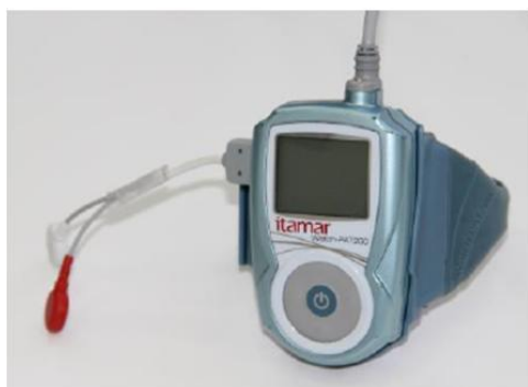
Figura 12 – Dispositivo Watch-PAT™ com cabo para pulseira de segurança
