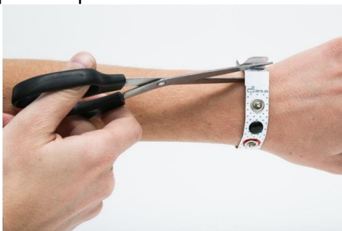
Figura 15 – Corte a pulseira de segurança no local especificado
