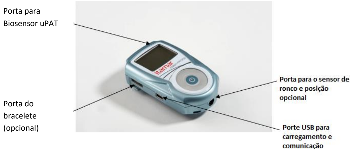
Figura 4 - Portas de serviço e periféricos
