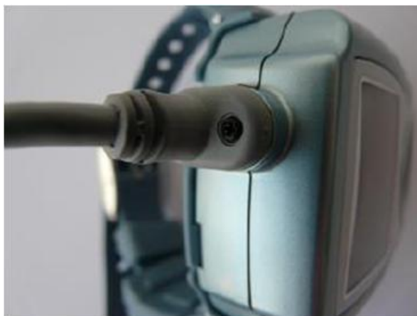
Figura 17 – Cabo do biosensor uPAT com parafuso
