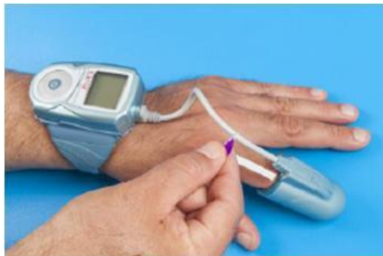
Figura 24 – Removendo o adesivo TOP
