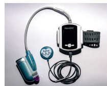
A – zintegrowany czujnik RESBP
